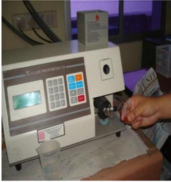
Fig 4. Lithium ion conc estimation
